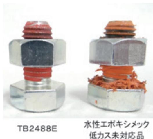
図-5 TB2488E ボルト締め後の外観
