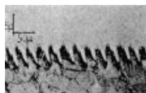
2図 精密旋削した銅面の斜め切断面。凹凸の高さは約5μ
