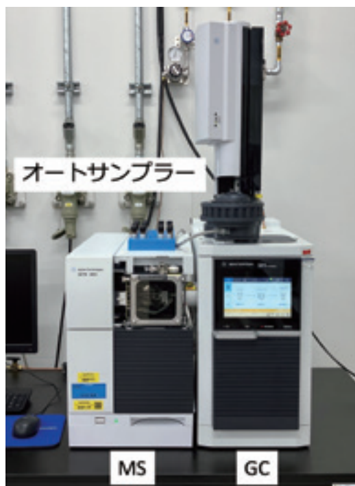
図-12 GC-MS(液打ち) (アジレント・テクノロジー社製)
