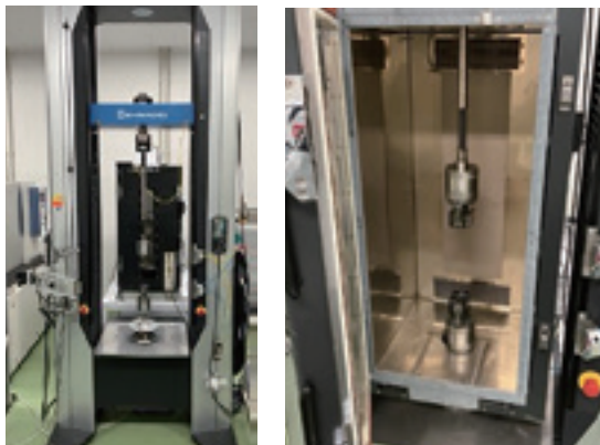
図-8 万能試験機と熱時測定(島津製作所社製)
