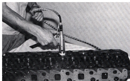
写真 11 ジーゼルエンジンシリンダーヘッド砂抜き穴内 周塗布例・3BコーターRTAH型
