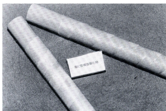
写真 - 4 SINX プリプレグによる塩ビ管補強硬化物
