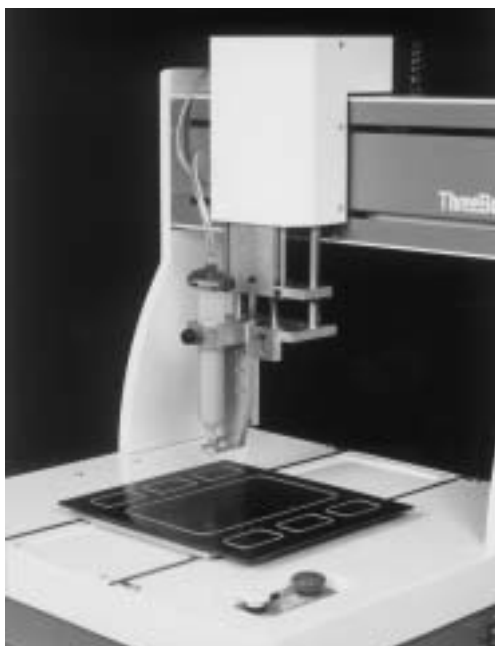
写真2, TB1152のFIPG塗布例
