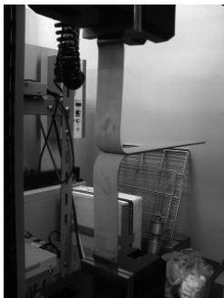
写真-2, T型はく離試験状況
