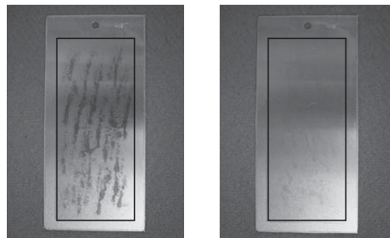
TB6644G無塗布 TB6644G塗布 写真-2 TB6644Gによる鉄粉保護効果
