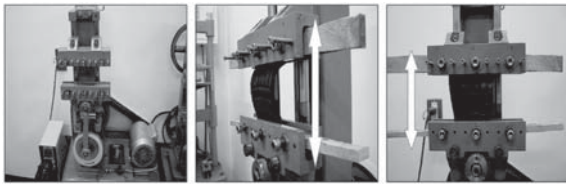
デマチャ試験機 上下動して試験片を屈曲させている
